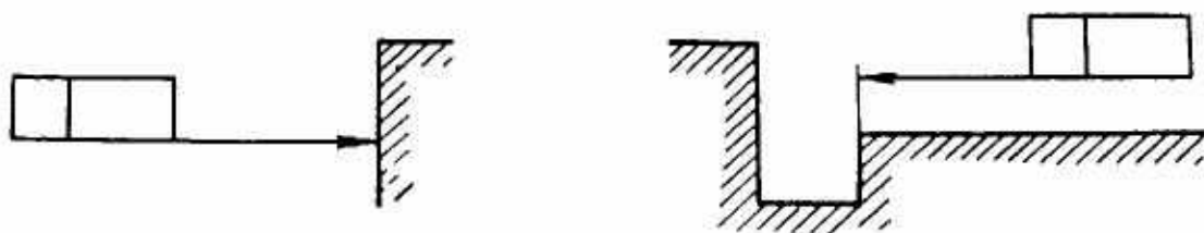
Рис.9.25. З'єднання рамок з контурами зображень поверхонь.
