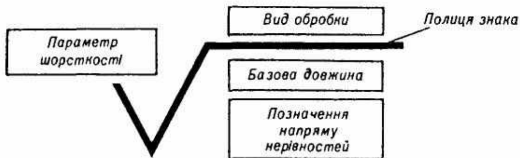
Рис.9.16. Структура повного позначення шорсткості поверхні на кресленні.
