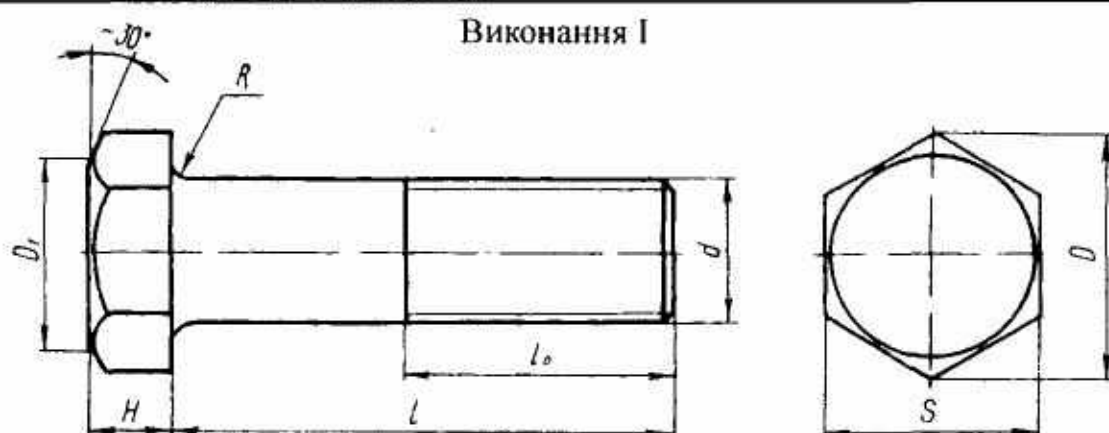
Таблиця 11.4 Болти з шестигранною головкою нормальної точності
